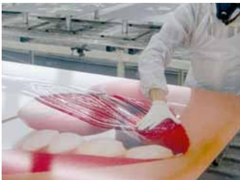
Der Zweikomponentenkunststoff wird unter genau definierten Bedingungen manuell auf das Foto gegossen und verteilt. Nach 8 bis 10 Stunden ist die glasklar durchgetrocknete Kunststoffschicht ausgehärtet
